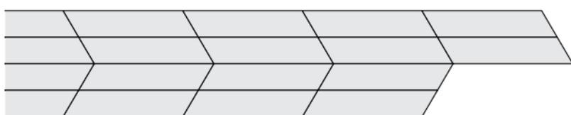
Nachdem drei bis vier Reihen zusammengesetzt sind, nochmals justieren. Verwenden Sie Klötzchen/Keile als Abstandshalter. Vergewissern Sie sich, dass die erste Reihe gerade ist. Überprüfen Sie das mittels einer Schnur, einem Richtscheit oder ähnlichem. Nun verlegen Sie den restlichen Raum auf die hier beschriebene Weise.
